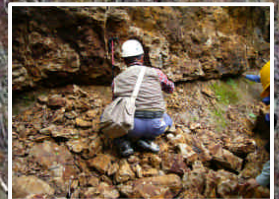
写真-3 浅層すべり面と押し出し
